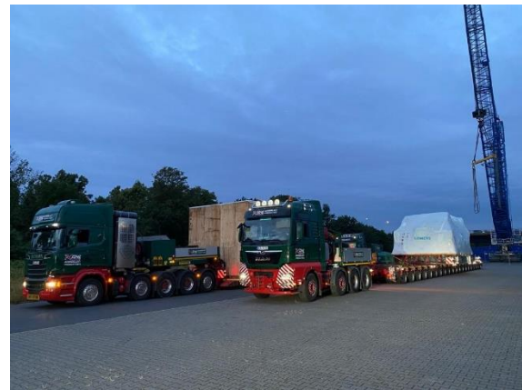
LKW-Anlieferung der Ölanlage und der Turbine im Alberthafen Dresden (Foto: SBO)
